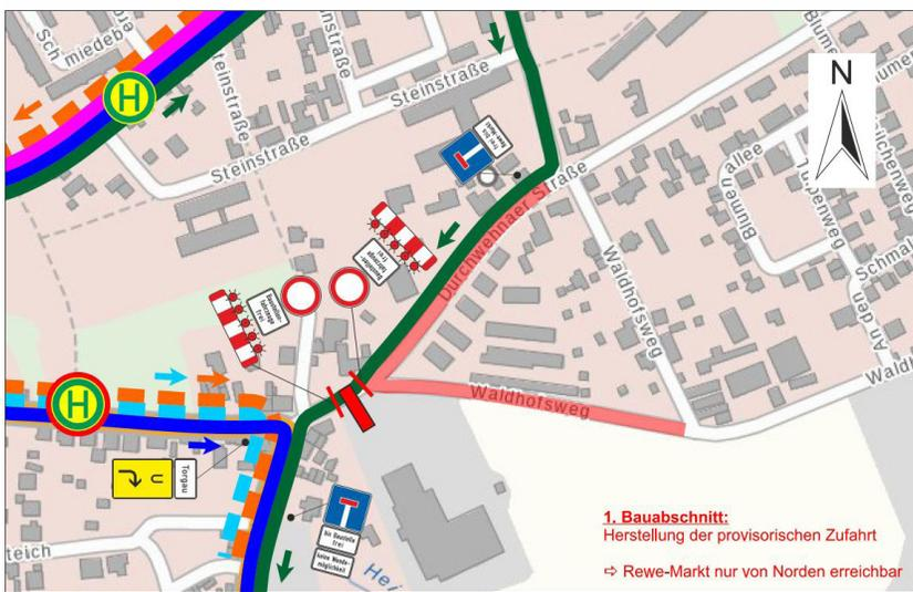
Die zeitweilige Zufahrt zum Einkaufszentrum wird als 7 Meter breite asphaltierte Straße mit einseitigem, 2 Meter breitem Gehweg und einem Gefälle zwischen 4 bis 5 Prozent hergestellt. Diese Zufahrt ist während der Bauphase für den Kundenverkehr genauso wie für den Anlieferverkehr zu den Märkten vorgesehen.
